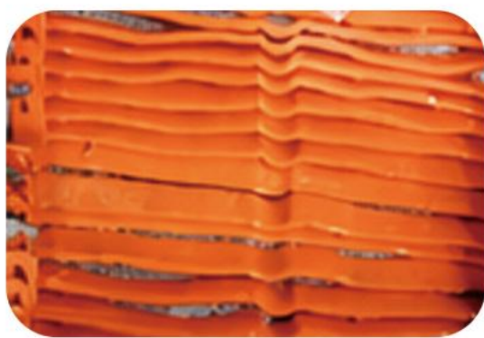
母线槽母排浸塑工艺(粉末)
